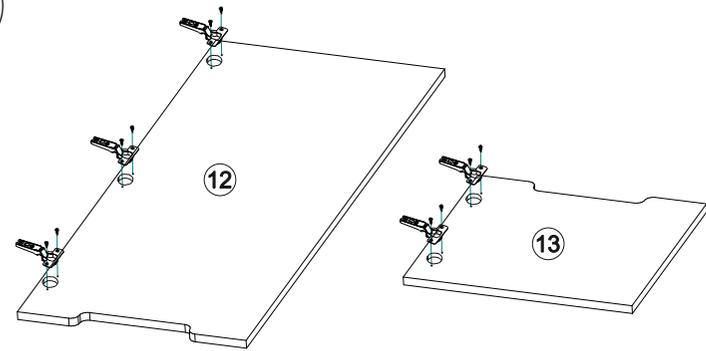
Регулирование зазоров и положения дверей с петлями
